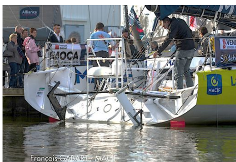
60' IMOCA Macif timonata da François Gabart, Vincitore della Vendée Globe 2012-2013. I due idrogeneratori in carbonio sono montati sullo specchio di poppa per poterli immergere e sollevare a secondo delle esigenze dello skipper.
