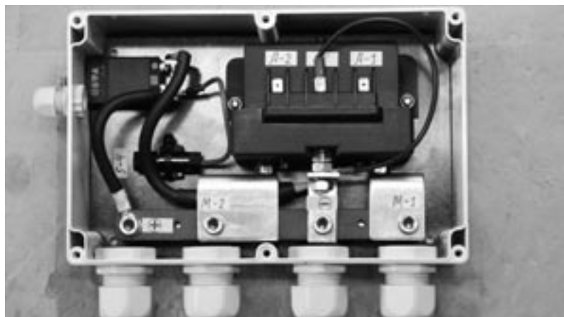
Schaltkasten 24V / control box 24 V
